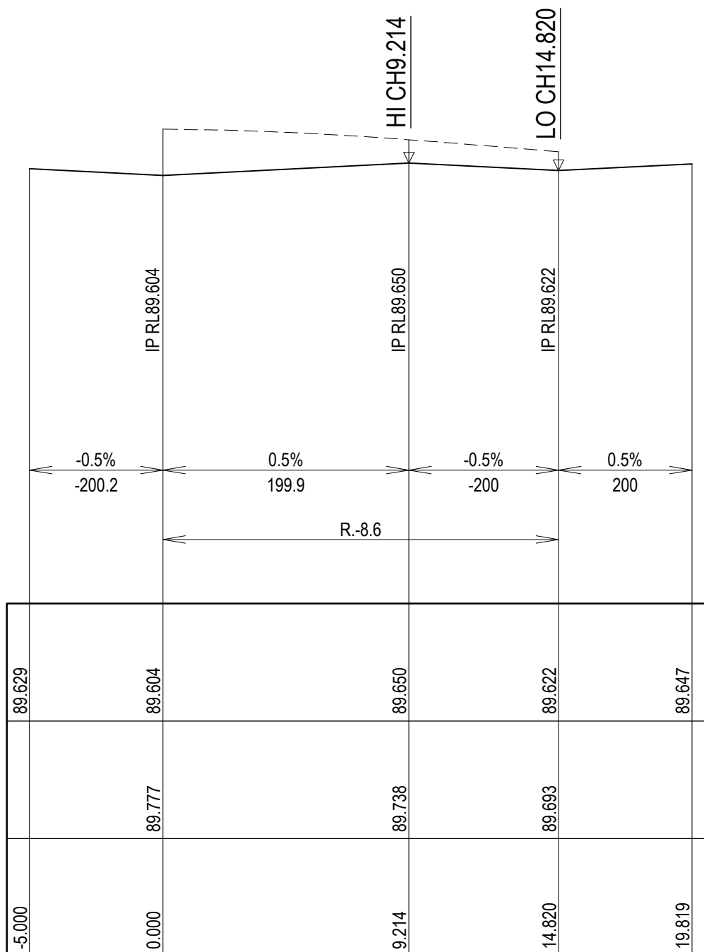
MK65 - LONGITUDINAL SECTION
